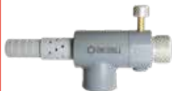
Cargador de anfo tipo pistola
